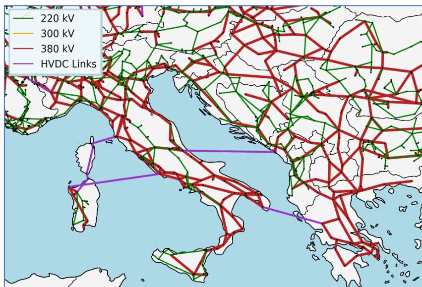
Slika 2.14. Mreža elektroenergetskih vodova (220 kV, 300 kV, 380 kV i vodovi jednosmjerne struje HVDC) području južne Evrope, sa uočljivom kvalitetnom povezanošću Crne Gore sa širim okruženjem kopnenom i podvodnom mrežom (Cavalieri et al., 2014).
